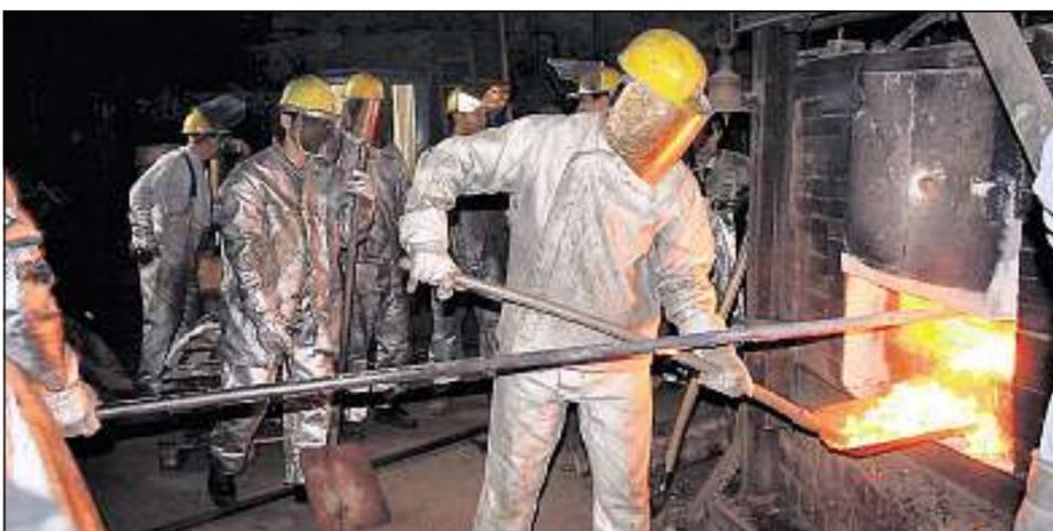
Durch ein Holzfeuer wird die Bronze (78 Prozent Kupfer, 22 Prozent Zinn) zum Schmelzen gebracht. Mit langen Fichtenstämmen wurde die glühende Masse im Ofen in Bewegung gehalten.
