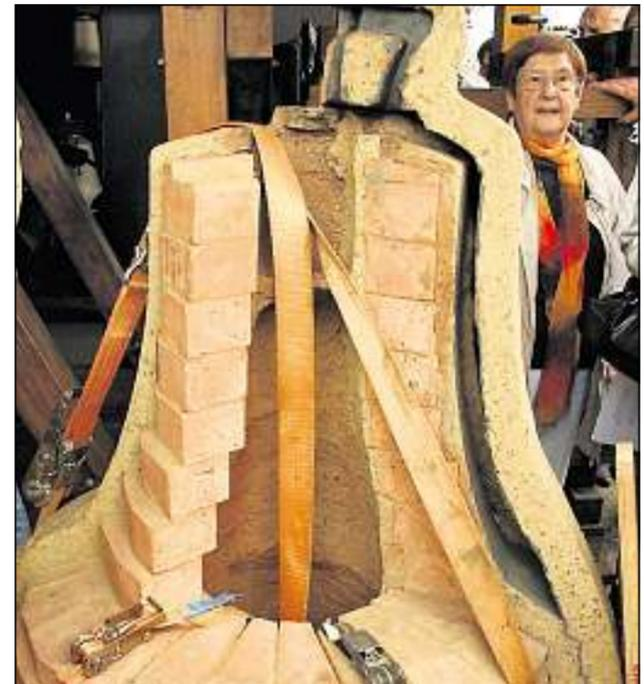
Der erste Formteil ist der Glockenkern. Er entspricht dem Inneren der Glocke und wird grob aus Ziegelsteinen aufgemauert.
